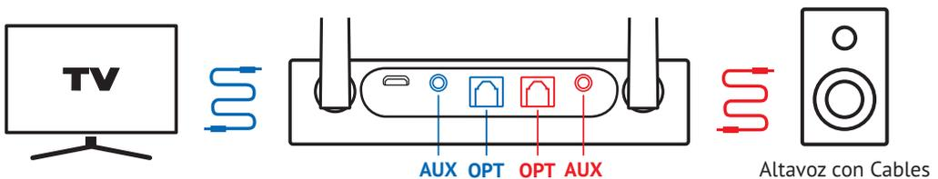
Conecte el puerto HearLink PLUS **TX** al televisor a través del cable óptico o de audio de 3,5 mm, y el puerto **RX** a un altavoz u otro equipo de audio periférico, utilizando el mismo tipo de cable que la conexión del puerto TX.
