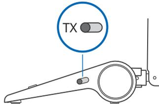
3. Conecte el puerto HearLink PLUS TX al televisor (u otro dispositivo) utilizando el cable óptico o de audio de 3,5 mm suministrado. El modo de conexión activa se indica con el texto iluminado HearLink PLUS TX (**OPT** o **AUX**) en el panel de visualización frontal del HearLink PLUS.
